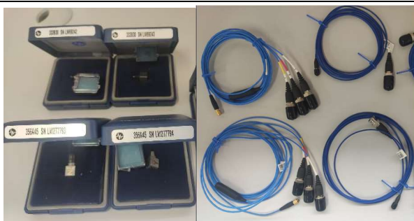
Fig. 9 – Acelerômetros e cabos BNC
