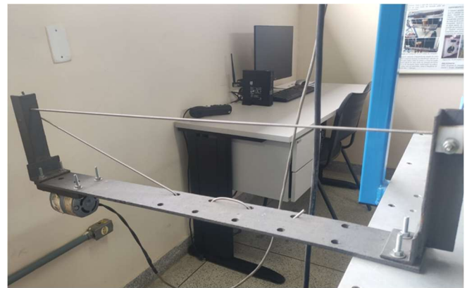
Fig. 14- Motor gerador de vibrações aplicado (nesta foto) para vibrações em cabos.
